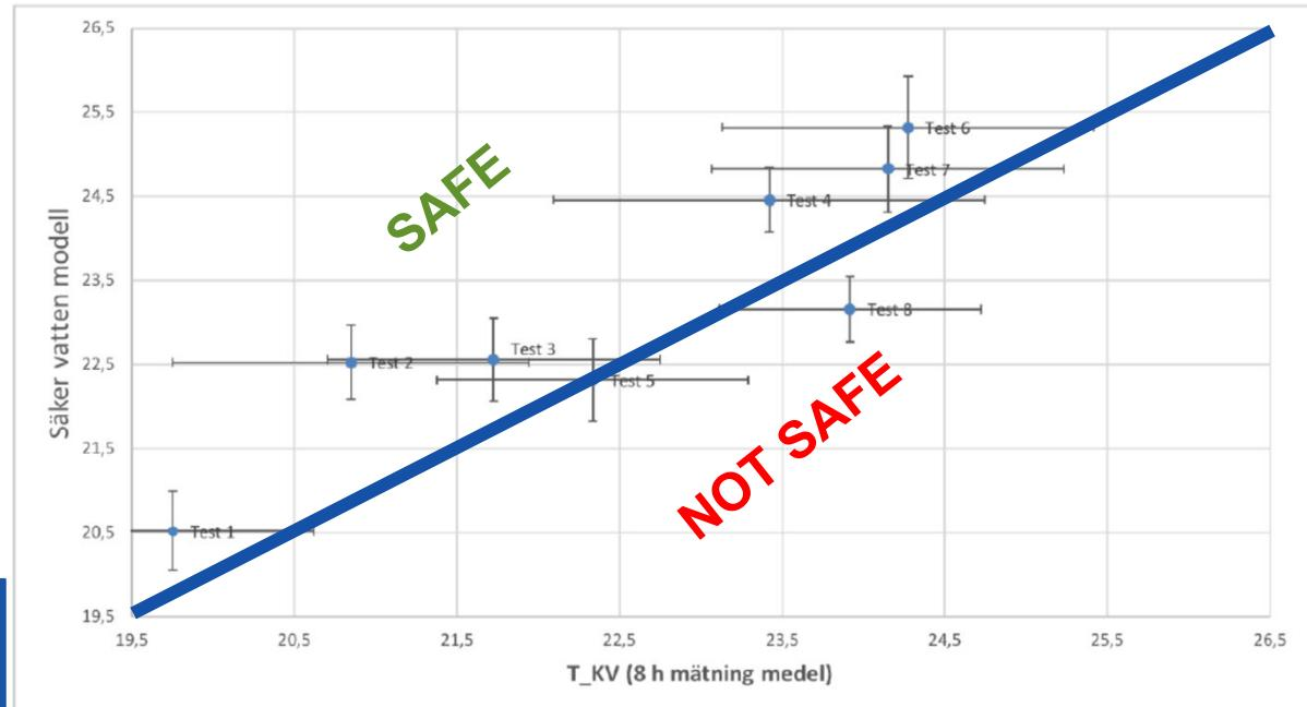
Figur 19: Osäkerhet för medeltemperaturen av termoelementen på KV
