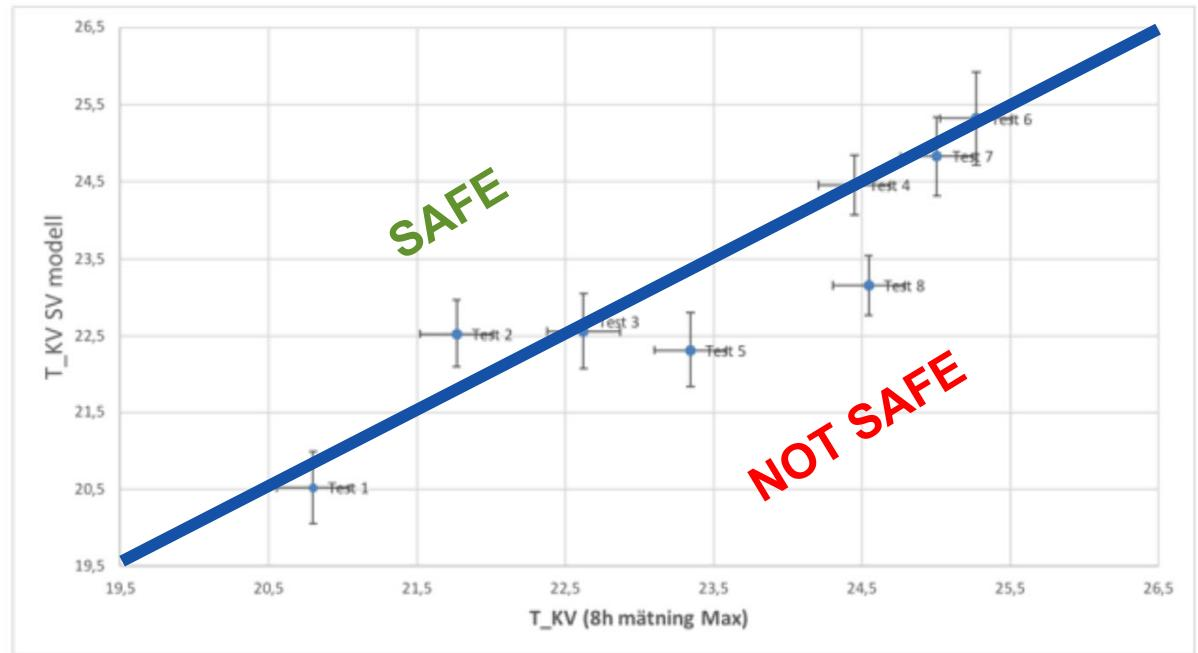
Figur 18: Osäkerhet för högst uppmätta temperatur av termoelementen på KV
