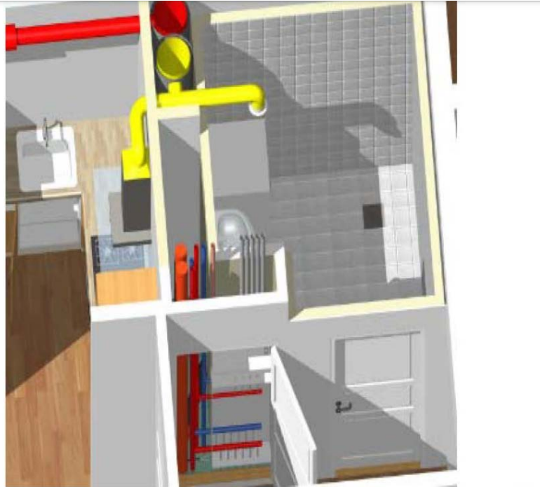
Sjaktløsning forbedringsprosjektet, ventilasjonskanaler skilt i egen sjakt
